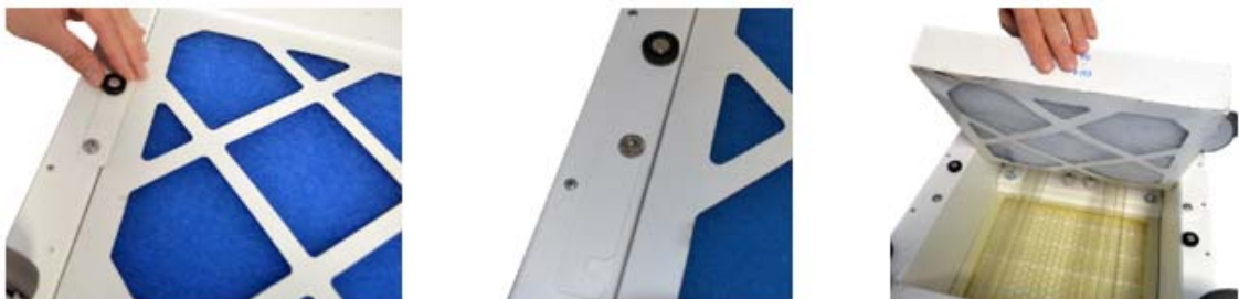
Abb. 26 Rändelmutter und Filterentnahme
