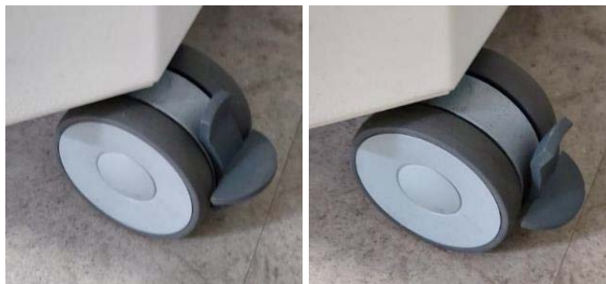
Abb. 6 Feststeller gelöst (links) und Feststeller betätigt (rechts)
