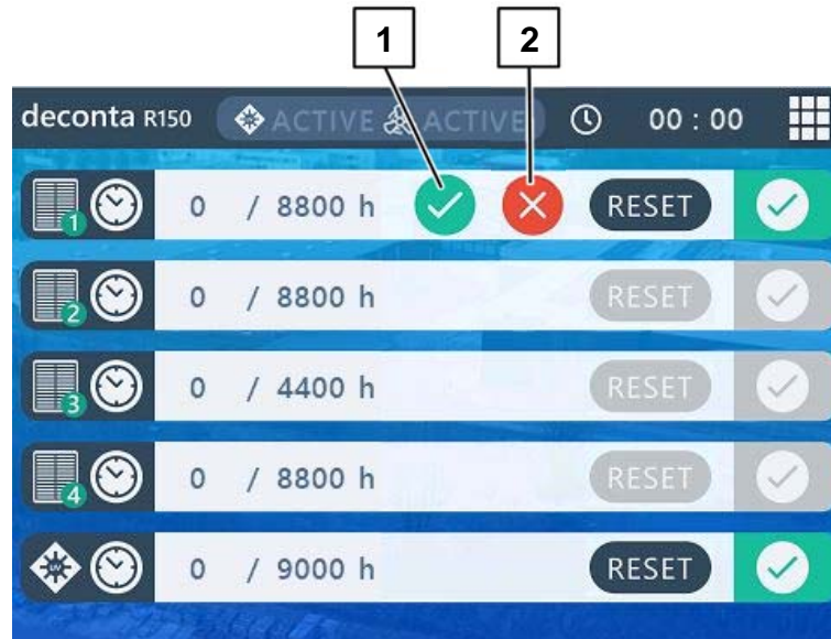
Abb. 16 RESET-Button für das Zurücksetzen der Betriebszeit
