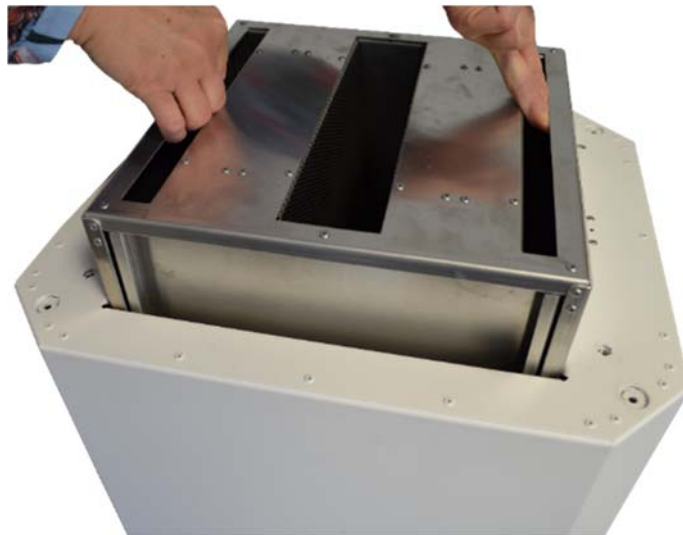
Abb. 34 Entnahme der Aktivkohlezelle
